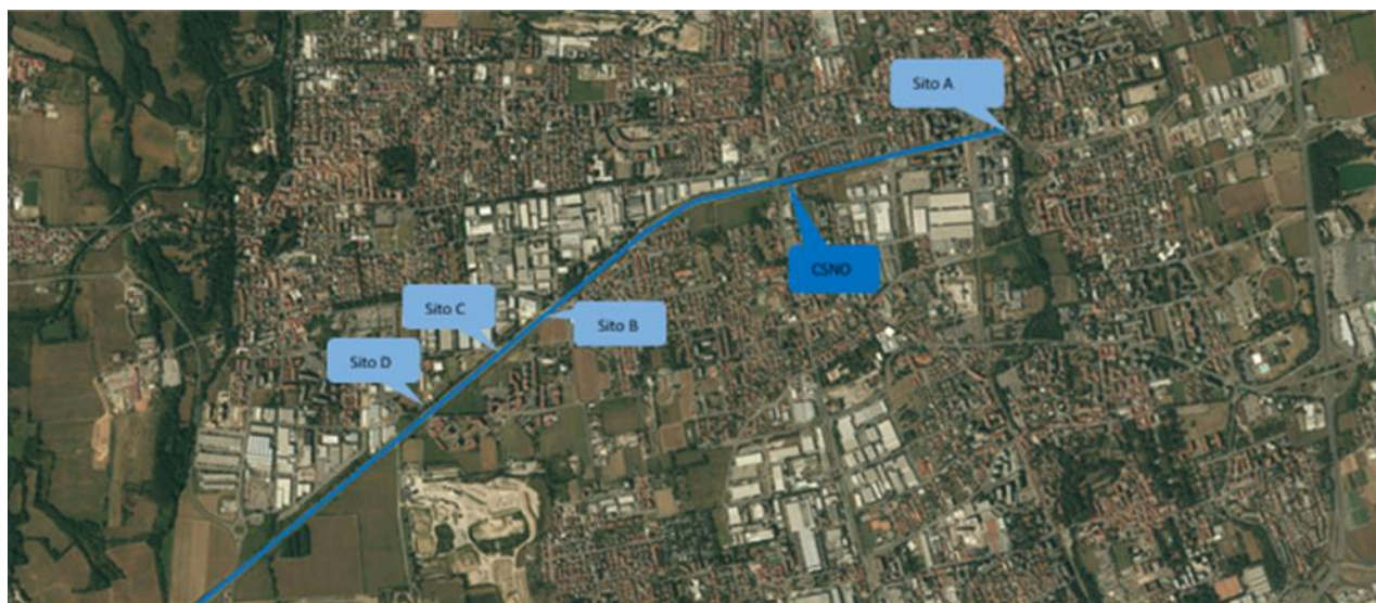
Figura 45 – Localizzazione delle quattro zone di prelievo del materiale sedimentato lungo il tratto del CSNO
