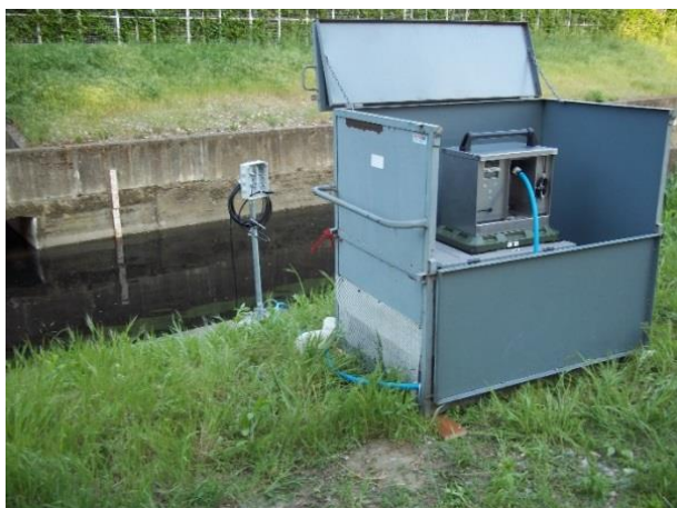
Figura 33 – Autocampionatore installato sul T. Seveso
