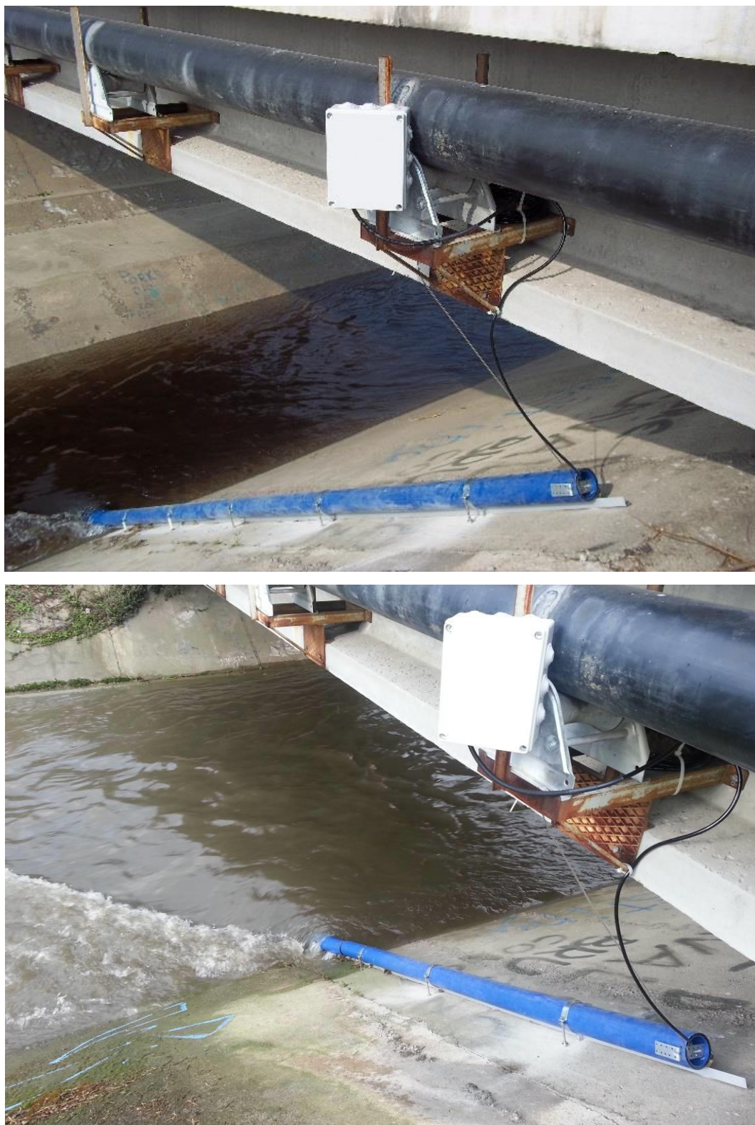
Figura 29 – Installazione della sonda S/N 13M101704 all'interno del CSNO
